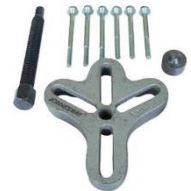
COD. 43312 EXTRACTOR de VOLANTE de DIRECCION AE310053 Yugo forjado 3 Tornillos: 3/8" X 24UNF x 3" Medida tornillo central: 15,5 x 140 mm Largo Empaque: 1 Tornillo 125mm 1 adaptador 3 Tornillos: 3/8" X 16 UNC x 3"
